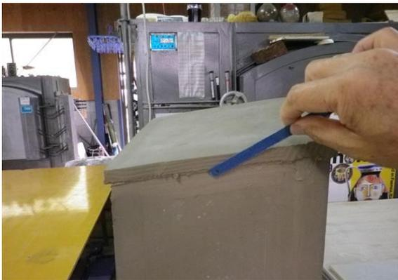
上面になるタタラの接着。エッジを鋭く削り出すのに私は金切ノコを使っています。
