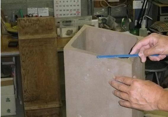
底、側面が組みあがり上面を接着する作業に掛かります。側面の面積を広げれば、中からボール状の物で叩き出し、少し面を膨らんだ形にしておきます。焼き上がった時に痩せて見えるのを防ぐためです。
