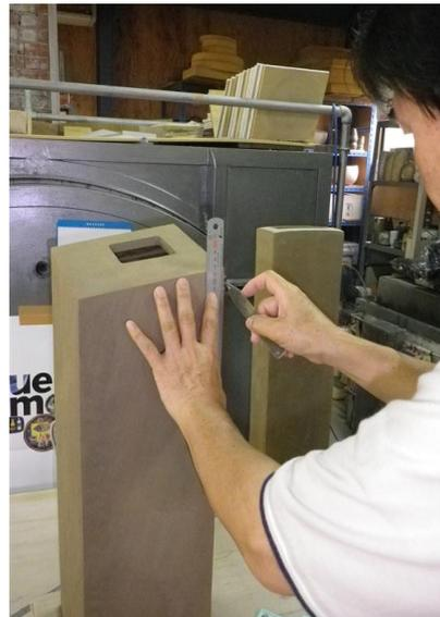
一日乾燥させてから、面とエッジの仕上げをします。乾燥を急ぐと歪んだり接着部分が切れてきたりしやすいので、ゆっくり時間をかけて乾燥させます。
