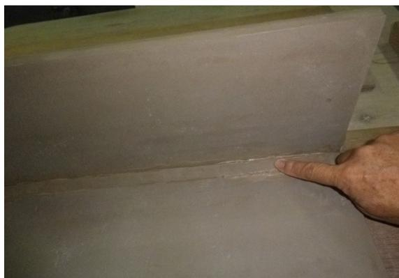
接着部内側に補強のためのヨリ（土をヒモ状にした物）を圧接します。
