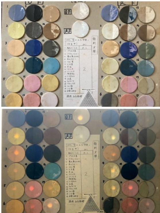
写真 2. 透光性磁器に種々の顔料を加えて作った試験片。
